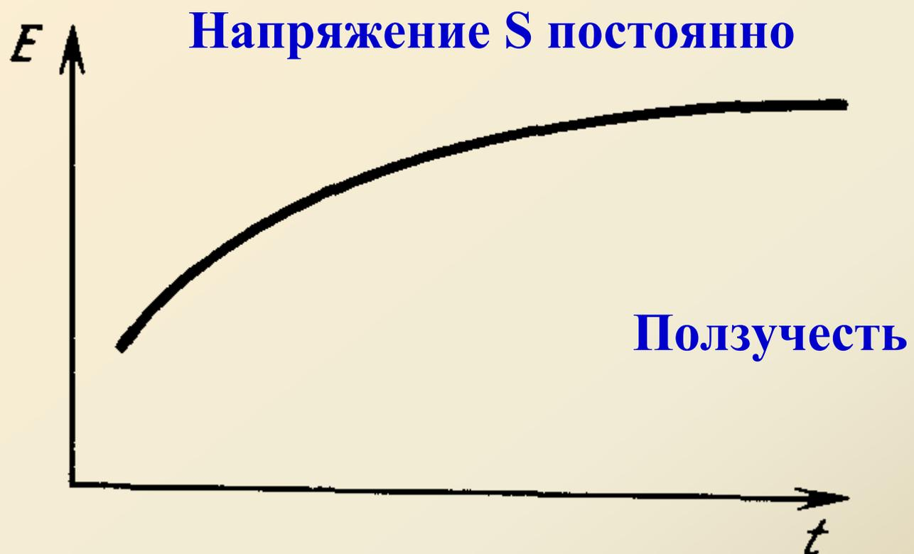
Механизм вязкого течения полимеров заключается в скольжении цепей друг относительно друга путем перемещения отдельных сегментов из одного равновесного положения в другое в результате теплового движения. Наличие внешней силы приводит к преимущественному перемещению сегментов в направлении силы, макромолекулы перестраиваются, вытягиваются и смещаются, а полимер в целом течет в направлении силы. При больших напряжениях возможны разрывы макромолекул с образованием свободных радикалов.
